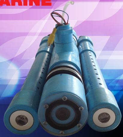
เรือดำน้ำต้นแบบลำนี้มีวัตถุประสงค์เพื่อสร้างเป็นยานดำน้ำสำรวจใต้น้ำได้ทั้งน้ำจืดและน้ำทะเล ดำน้ำลึกได้ไม่เกิน 15 เมตร โครงสร้างถูกออกแบบให้เบาด้วย PVC และมีความง่ายต่อการประกอบซ่อมแซม ติดตั้งอุปกรณ์เซนเซอร์แบบต่างๆ เช่น กล้อง CCTV เซนเซอร์วัดอุณหภูมิ เซนเซอร์วัดความดัน เป็นต้น โดยข้อมูลที่วัดได้จะถูกส่งกลับมาที่ผู้บังคับยาน ที่อยู่บนผิวน้ำหรืออยู่บนบกแสดงในมอนิเตอร์ ประโยชน์ที่ได้จากงานสำรวจในโครงการนี้จะทำให้ทราบถึงคุณภาพของแหล่งน้ำต่างๆ รวมถึงประยุกต์ใช้งานด้านเกษตรกรรมและปศุสัตว์ได้อีกด้วย
