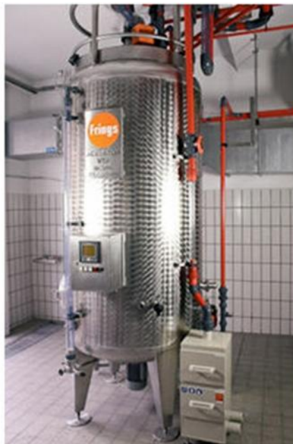
ภาพถังหมักที่มีระบบการให้อากาศอย่างต่อเนื่อง (Frings Acetator)
